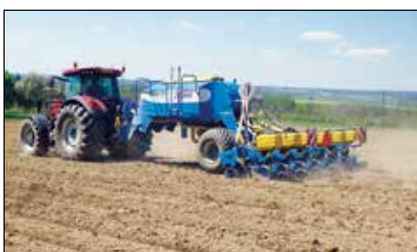
Nesený secí stroj pro výsev širokořádkových plodin.
