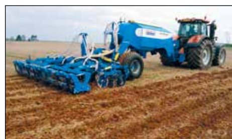
Nesený kyprič pro pásové zpracování půdy Strip-Till.
