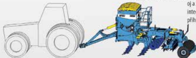
Falcon HW + Digger N Fert+ | doplňkový nosič s nápravou, zásobník hnojiva, přihnojování do 2 horizontů
