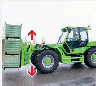
BSS – hydropneumatické odpružení ramene (volitelná výbava) ovládané obsluhou. Zrychluje přesuny, chrání náklad a zvyšuje produktivitu. Deaktivace při rychlosti nižší než 3km/h.
