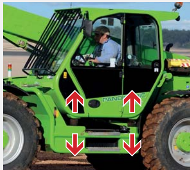
Hydropneumatické odpružení ovládané obsluhou. Jediná kabina svého druhu na trhu.
