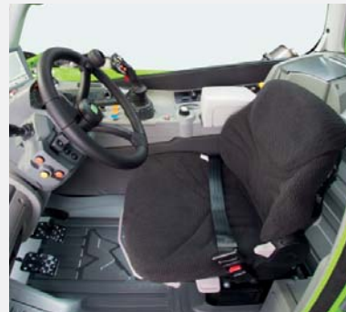
Pneumaticky odpružené sedadlo pro větší pohodlí.
