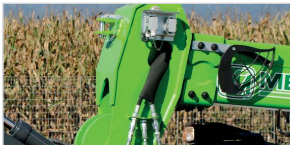
Trubky, elektrické kabely a hydraulická vedení umístěné uvnitř ramene – maximální ochrana
