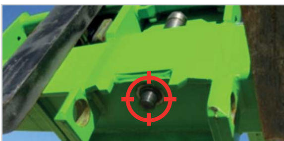
Tac-Lock: systém hydraulického připojení adaptéru ovládaný z kabiny
