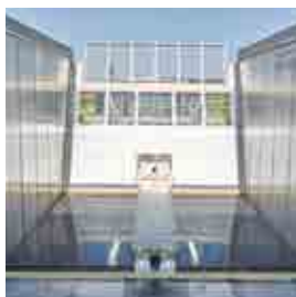
Provedení vyhrnovacího čela "Insight" vyrobené z materiálu odolného proti nárazu k zlepšení průhledu a kontroly nákladu
