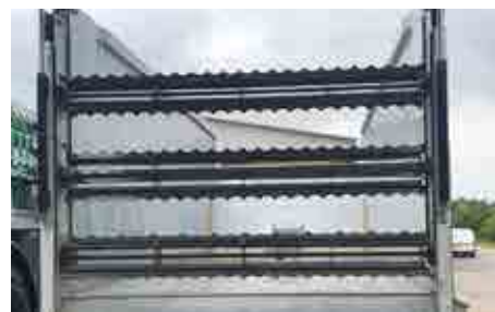
Dávkovací válec se 3 ležatými frézovacími válci
