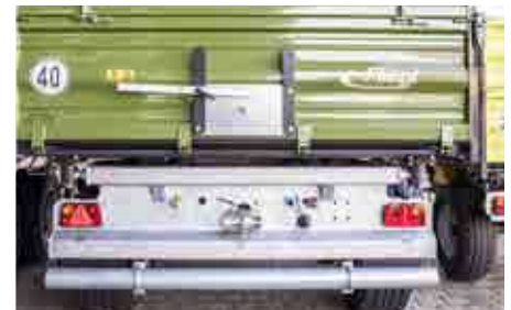
Provedení 40 km/h s ochranou proti podjetí a blatníky
