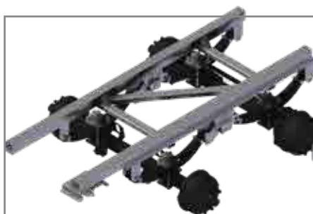
Tandemový agregát Gigant (TMK 200 od délky korby 5,65 m)
