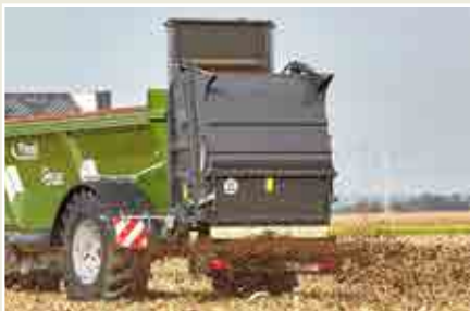
Talířový agregát k rozmetání do široka varioSPLASH umožňuje rozmetání do šířky až 32 m.
