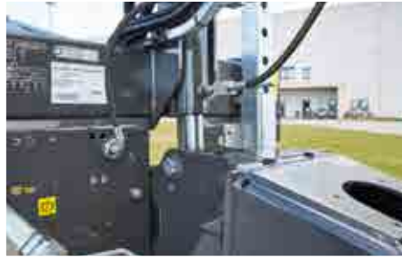
Hydraulické odpružení oje
