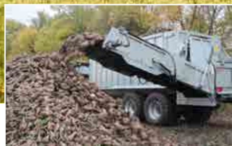
Překládací pás RUBY na cukrovou řepu Výkon překládání cca: 15 m 3 /min
