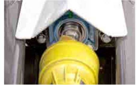
Hydraulika 60 litrů (volitelně 90 l) poháněná vývodovým hřídelem s hydraulickým čerpadlem a olejovou nádrží
