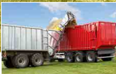
Překládací pás »MobilFast« (až 30 m 3 /min)
