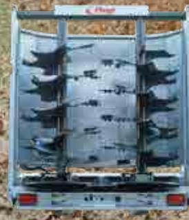
Frézovací válec s vyhazovacími lopatkami
