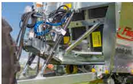
Hydraulické odpružení oje, nejlepší jízdní komfort
