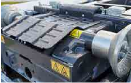
Velké výstupní válce z ocelolitiny (Ø 310 mm) s velkou středovou tyčí usnadňují natažení kontejnerů.
