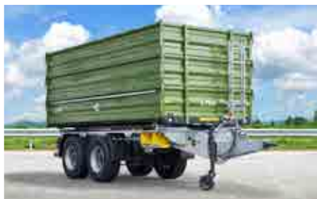
TDK 160 s nástavbou 1800 mm (bočnice 3 x 600 mm)
