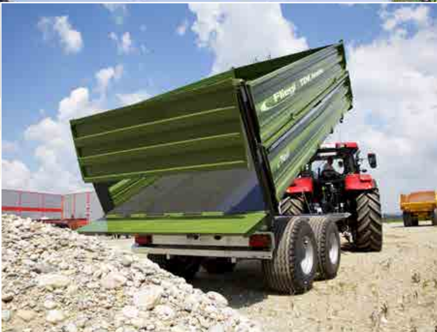
TDK 160 s hydraulickou šterkovou klapkou 500 mm Korba z oceli 450 HB odolávající opotřebením, rohové sloupky svařované. Korba: 5000 × 2320 × 2220 mm
