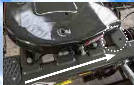
Mechanické nastavení podkovy tahače pro jednonápravový a tandemový přívěs s točnou
