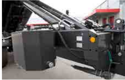
Hydraulika 60 litrů (volitelně 90 l) poháněná vývodovým hřídelem s hydraulickým čerpadlem a olejovou nádrží
