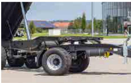
Jednonápravová točna vpředu
