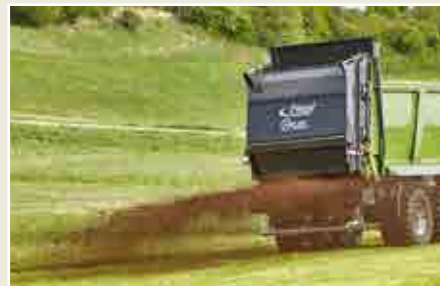
Talířový agregát k rozmetání do široka varioSPLASH umožňuje rozmetání do šířky až 32 m.
