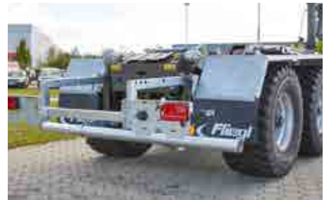
Volitelně: Hydraulická podpěra na nápravě
