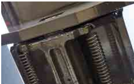
Automatické zajištění háku během sklápění
