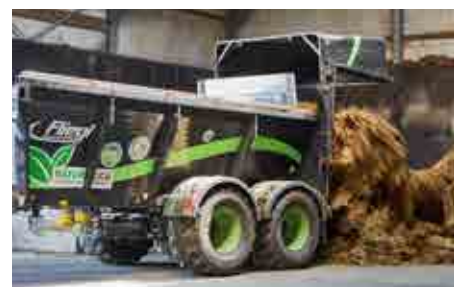
Systém ADS lze volitelně vybavit velkoobjemovou zadní stěnou 800 mm a využít jej jako přepravní návěs
