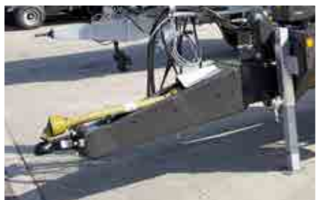
Otočná tažná oj pro horní a dolní zavěšení
