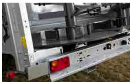
Lehké provedení: liníkové bočnice
