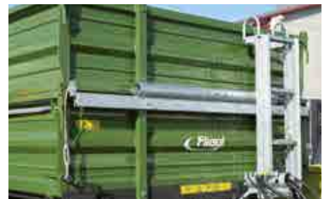
Volitelně: Tažná pružina bočnic v těžkém provedení
