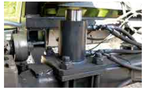
Volitelně: Hydraulická podpěra na nápravě
