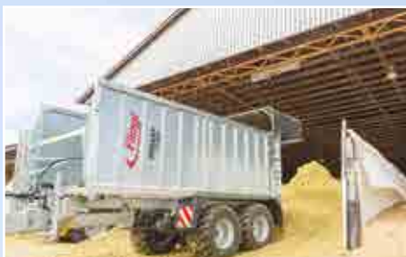
Vyhrnování, žádné vyklápění – bez problémů i v nízkých halách.
