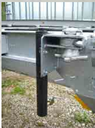
Válce pro hydraulické zvedací zařízení
