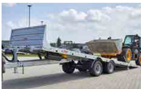
Hydraulicky sklopné oje
