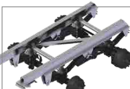
Tandemový agregát »Gigant Plus«
