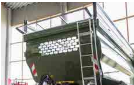
Mechanicky sklopná ochranná mříž
