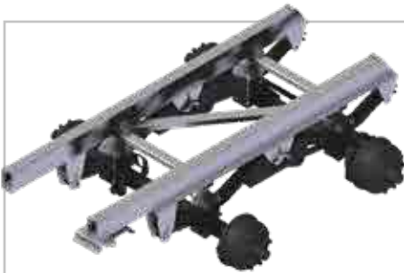
Tandemový agregát »Gigant Plus«
