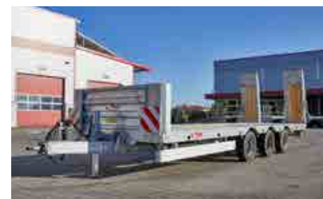
TPA 370 Čelní stěna 800 mm v sériové výbavě Nájezdová rampa sklopná
