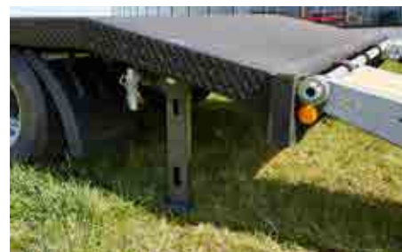
Podpěra zádi se 2 skládacími podpěrami
