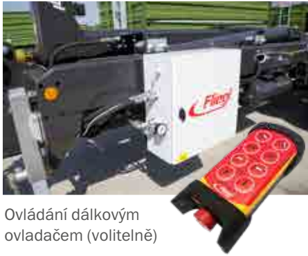
Hydraulické odpružení oje
