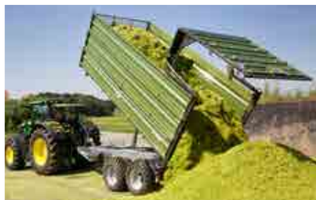
Silážní sklápěč s hydraulickou zadní stěnou
