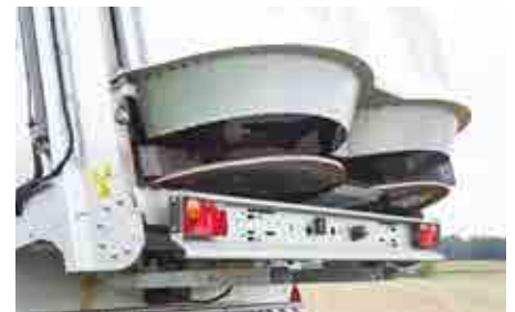
Frézovací válec s vyhazovacími lopatkami
