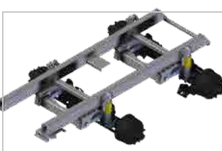
Hydraulické pružení náprav
