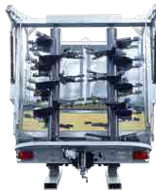
Frézovací válec s rozmetacími lopatami
